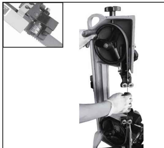
Мал. 14 Типове встановлення леза
