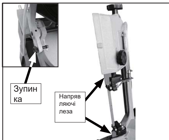
Мал. 13 Захист напрямних лез та кріплення
