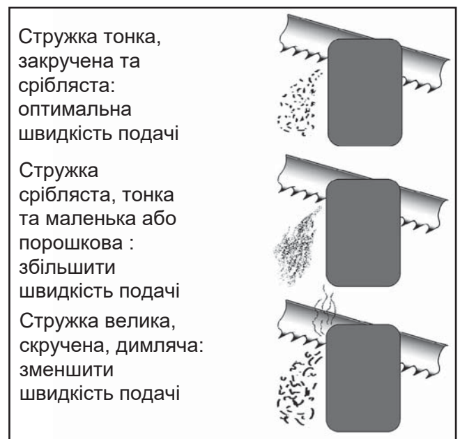
Мал. 14 Характеристики стружки
