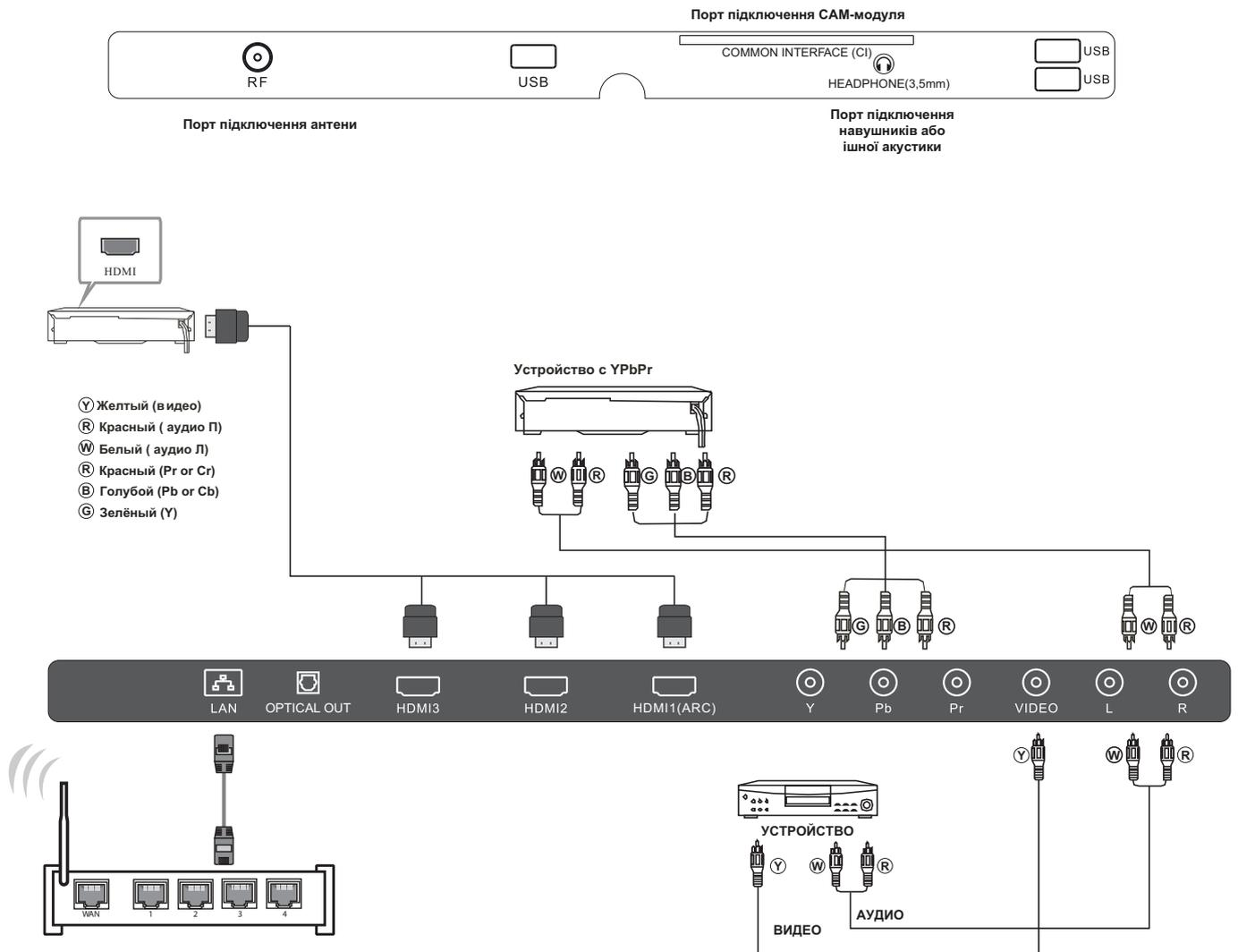
ТВ может быть подключен к следующим устройствам: видеомаягнитофону, DVD проигрывателю, видеокамере, игровой приставке, стереосистеме и др. Порт YPbPr поддерживает следующие форматы видео: 480i, 576i, 480p, 576p, 720p, 1080i, 1080p, 2160p, 2160i.
