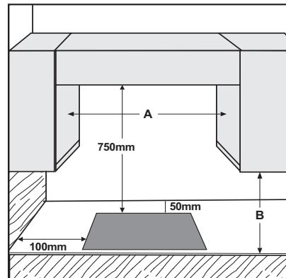
**ПРИМІТКА.** Якщо відстань «А» між настінними шафами має значення в діапазоні від 600 до 730 мм, висота «Б» повинна мати значення принаймні 530 мм. Якщо відстань «А» між настінними шафами більша за ширину варильної поверхні, висота «Б» повинна мати значення принаймні 400 мм. У разі встановлення витяжки над варильною панеллю див. інструкції виробника витяжки, щоб визначити правильну відстань.
