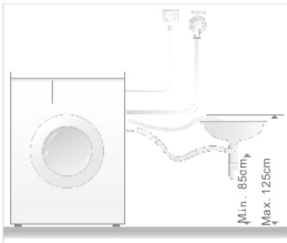
Інструкція з встановлення труби
