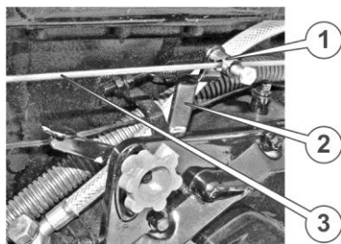
Рисунок 29. – Тяга подачі палива
