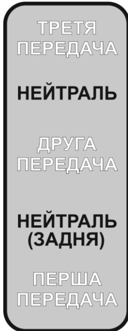
Рисунок 4.12. Послідовність перемикання передач
