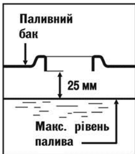
Рисунок 18. – Горловина паливного баку
