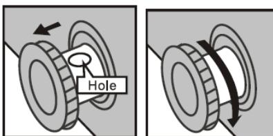
• Поверните диск на 180 градусов, чтобы вода стекла в поддон. Когда вся вода выльется, задвиньте диск сливного отверстия. Закройте пробкой сливное отверстие внутри морозильного ларя. **Примечание:** следите, чтобы поддон не переполнился.
