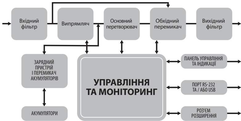
Мал. 7. Блок-схема ДБЖ
