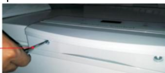
Закрепите ручку на двери с помощью винтов
