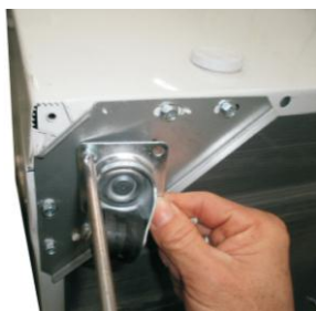
Закрепите колеса с помощью отвертки
