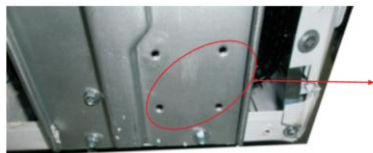
Закрепите универсальное колесо, винт которого в коробке
