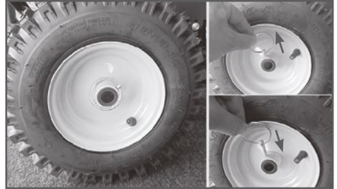
Мал.17 Установка шплінта на левом колесе
