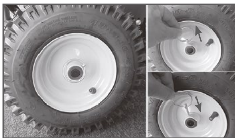
Рис.17 Установка шплинта на левом колесе
