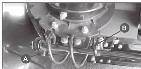
Рис.4 Установка рычага поворота желоба (нижняя часть)
