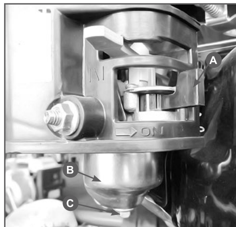
Рис.18 Видалення палива з бака
