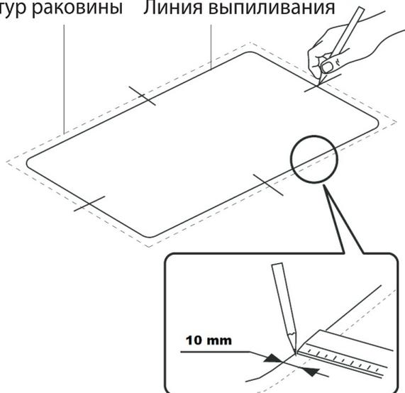
**3.2.** Чтобы вставить пилу, просверлите первое отверстие сверлом (внутри линии реза).
