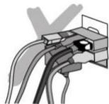
Запрещается подключать к одной розетке другие приборы одновременно с мультиваркой.
