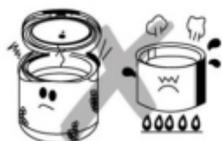
Устанавливайте прибор на ровной, устойчивой поверхности. Не ставьте мультиварку на кухонные плиты, другие электроприборы, а также вблизи других источников тепла. Внутреннюю кастрюлю не разрешается использовать на других нагревательных приборах.
