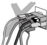
Vairāku iekārtu izmantošana vienā kontaktligzdā var izraisīt tās pārkaršanu, kas var izraisīt aizdegšanos vai nelaimes gadījumu.
