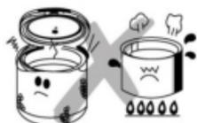
Novietojiet iekārtu uz līdzenas un stabilas pamatnes. Nenovietojiet multikatlu uz plīts, citām elektoiekārtām, kā arī tuvumā citiem sildelementiem, lai izvairītos no deformācijas, kas var sabojāt iekārtu. Iekšējo katliņu nedrīkst izmantot uz citiem sildelementiem.
