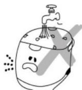
Nemazgājiet multikatla korpusu ūdenī vai citā šķidrumā. Ja tas tomēr ir nokļuvis ūdenī, nekādā gadījumā nepieskarieties korpusam, bet nekavējoties atvienojiet ierīci no elektrotīkla, lai izvairītos no negadījumiem.
