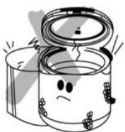
Ir aizliegts ieslēgt multikatlu bez izņemamā katliņa vai ar tukšu katliņu, lai izvairītos no iekārtas sabojāšanas.
