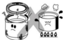
Paigutage masin tasasele kindlale pinnale. Ärge pange multikeetjat köögipliidile, teistele elektriseadmetele, samuti mitte muude soojusallikate lähedusse, et vältida deformatsiooni, mis võib viia masina rikkeni. Sisemist kastrulit ei tohi kasutada muude kuumutusseadmetega.
