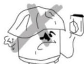
Gatavošanas laikā vai arī kad ir aktivizēts siltuma uzturēšanas režīms, tvaika izvades atvere nedrīkst būt nosprostota, tas var sabojāt multikatlu.
