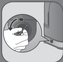
**FI** Laita laite pesualtaan päälle ja kierrä "kalkinpoistokorkki" auki kääntämällä sitä vastapäivään.
