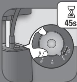
**CZ** Zařízení zapnete otočením hlavního vypínače. Poté nastavte výstup páry otáčením knoflíku.
