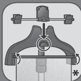
**CZ** Přidejte vertikální podporu a ramínko.
