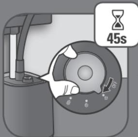
**RU** Поверните переключатель, чтобы включить устройство. Затем выберите с помощью переключателя мощность паровой струи.
