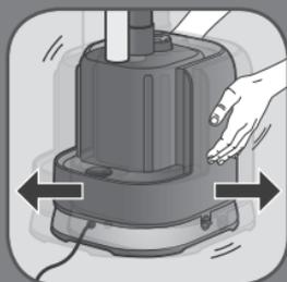
**FI** Ravistele laitetta varovasti likahiukkasten irrottamiseksi.
