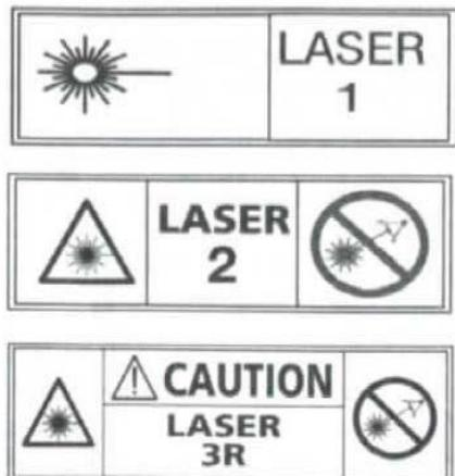
**⚠️ ОБЕРЕЖНО** При роботі з лазерним інструментом уникайте потрапляння червоного лазерного променя в очі. Тривала дія лазерного випромінювання може становити небезпеку для очей.
