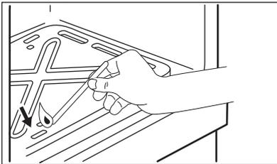
3. Одновременно нажмите на ручку выбора режимов духового шкафа и поверните ее против часовой стрелки в положение, соответствующее максимальной подаче газа.
