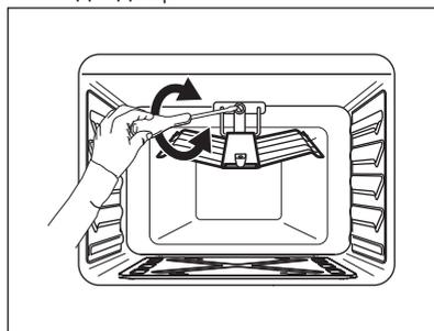
3. Соберите горелку, действуя в обратной последовательности. Прежде чем затянуть винт крепления убедитесь, что горелка правильно вставлена в заднюю панель.
