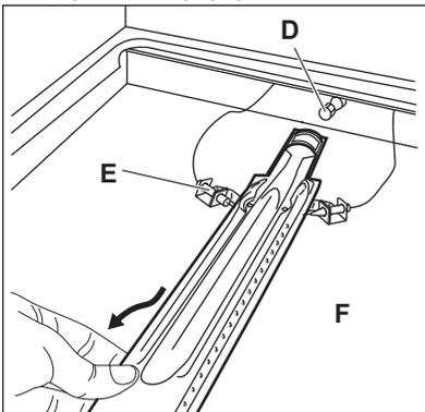
4. Плавно переместите ее влево. Убедитесь, что втулка горелки находится в сопле горелки. Не прилагайте усилия к проводу, идущему к разъему свечи зажигания F и к проводу термопары E.
