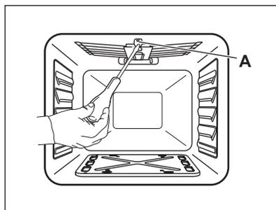
2. Выверните инжектор горелки с помощью торцевого ключа на 7 мм и замените его на инжектор подходящего типа.
