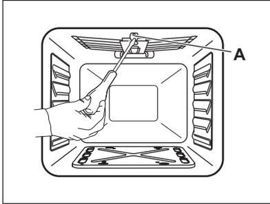
2. Відкрутіть форсунку конфорки торцевим ключем на 7 мм і замініть її.
