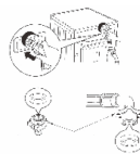
З'єднувач для труби подачі води з гумовим ущільненням
