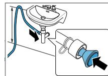
Зафіксуйте точку підключення за допомогою затискача шланга (12-22 мм). Закріпіть зливний шланг за допомогою направляючої для шланга на
