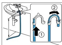
Повністю проштовхніть водовідвідний шланг через і закріпіть його кріпильним матеріалом. Закріпіть закруглене кріплення на висоті не більше 100 см.
